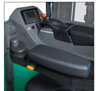
Mini-Lenkrad mit schwimmend gelagerter Armlehne
