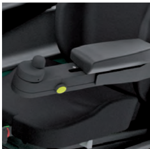
Mini-Lenkrad mit schwimmend gelagerter Armlehne
