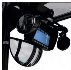
Am Hubgerüst montierter Kameramonitor
